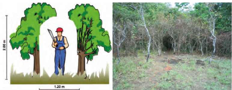
Figura 72. Características típicas de la llamada pica ecológica tipo túnel en un proyecto sísmico en zona boscosa. No se cortan árboles con diámetros mayores a 10 cm. Guía ambiental.
