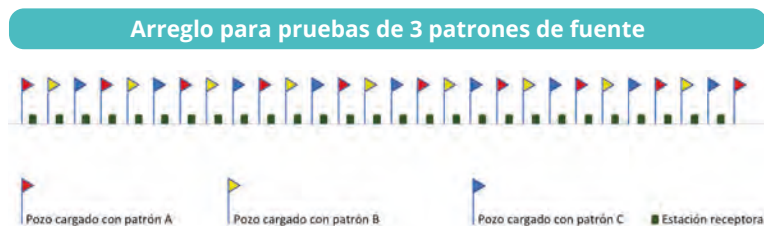
Figura 60. Ejemplo de un esquema para evaluar tres patrones de fuente diferentes con base en tres secciones sísmicas de igual longitud. 240 Estaciones de receptoras separadas 20 m entre sí permiten analizar 3 apilados de 4.8 Km de largo con un fold máximo de 80.
