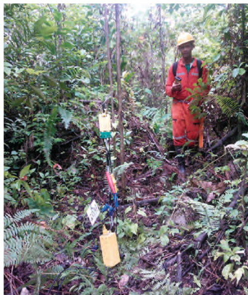
Figura 53. Ejemplo de una estación autónoma de grabación del sistema Autoseis, como las utilizadas en Colombia en 2014 según reporta Alfonso (2015).
